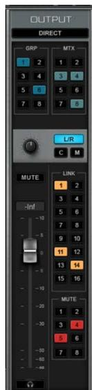
これらのグループでは、選択したチャンネルのミュート、ミキサーチャンネルのルーティング、チャンネルルーティングの出力パスへの設定、複数チャンネルのフェーダーのリンクといった操作が可能です。
