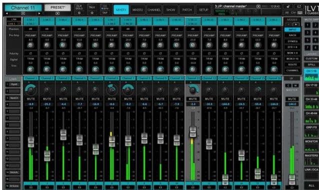
デフォルトでeMotion LV1 Classicは **Mixer 1 Window** を表示します。ここでは、プリアンプ、パン、チャンネルゲイン、ミキサーモード、Aux send、ルーティング、プラグイン処理をコントロールすることができます。トップバーからは他のコントロールとコンフィギュレーション・オプションに素早くアクセスできます。
