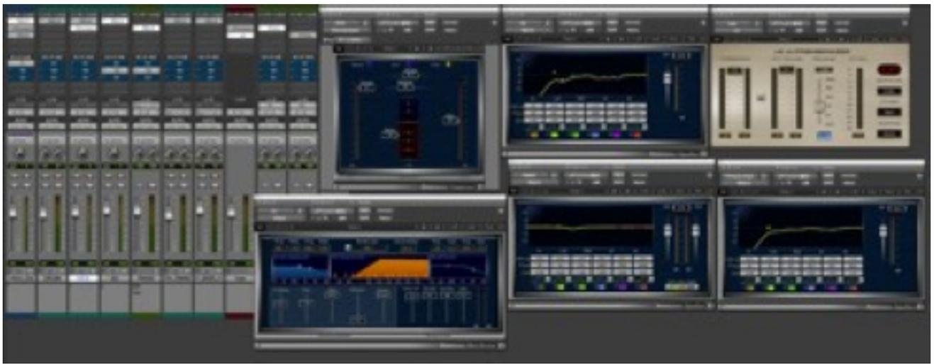
マスターチャンネルには WAVES の Renaissance Compressor が遅めのアタックタイムで軽く掛けられたあと、WAVES L2 でピークを超えない程度にリミッティング。マキシマイズ的な効果では使用されていない。
